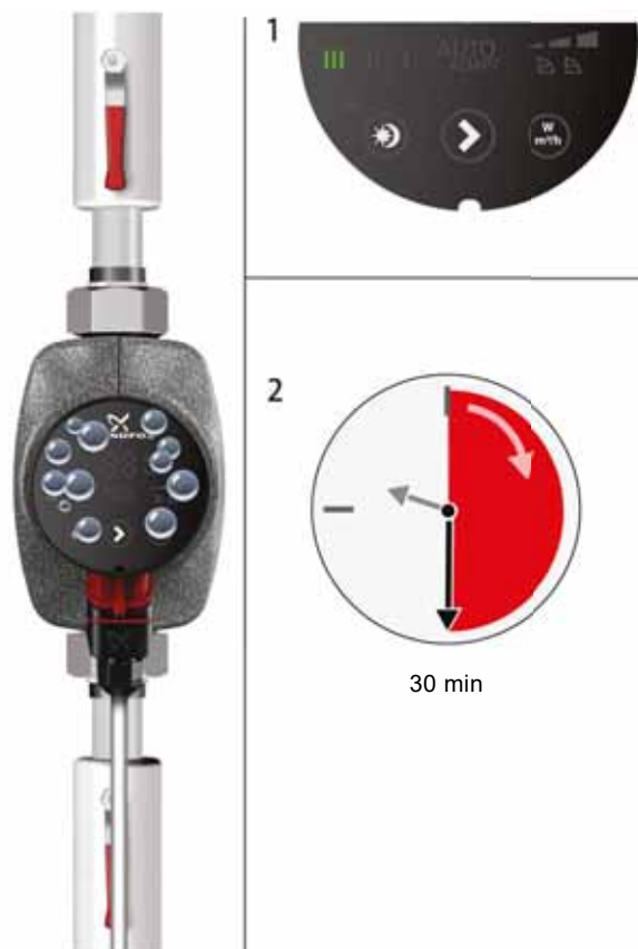
Fig. 8 Purge du circulateur
