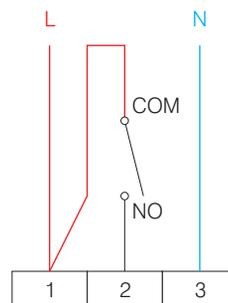
Servomoteur de vanne mélangeuse (SM 100 ou SM 80)
